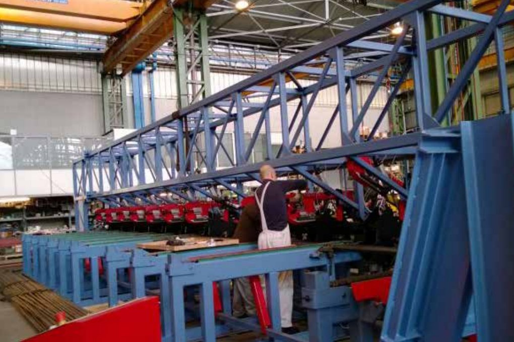
11 teste automatiche per taglio tiranti Ø 10-120 mm da 1 a 12 m - 11 automatic heads for rebar cutting, Ø 10-120 mm, lengths from 1 to 12 m
