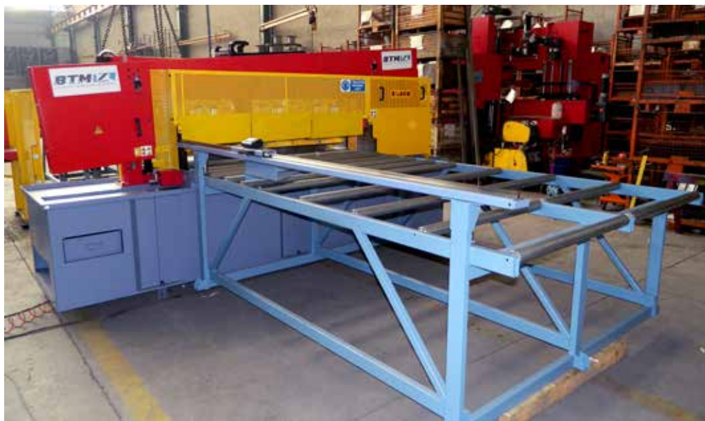
Taglio grigliati 2.000 x 150 mm Steel grating cutting 2.000 x 150 mm
