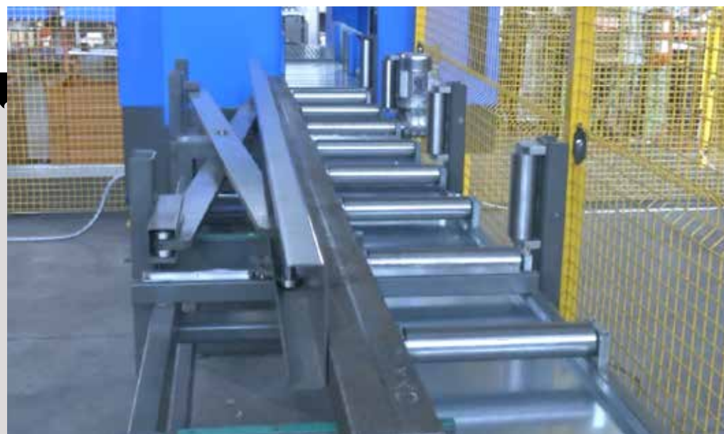
360 TCT con caricatore a una postazione 360 TCT with single station loading device
