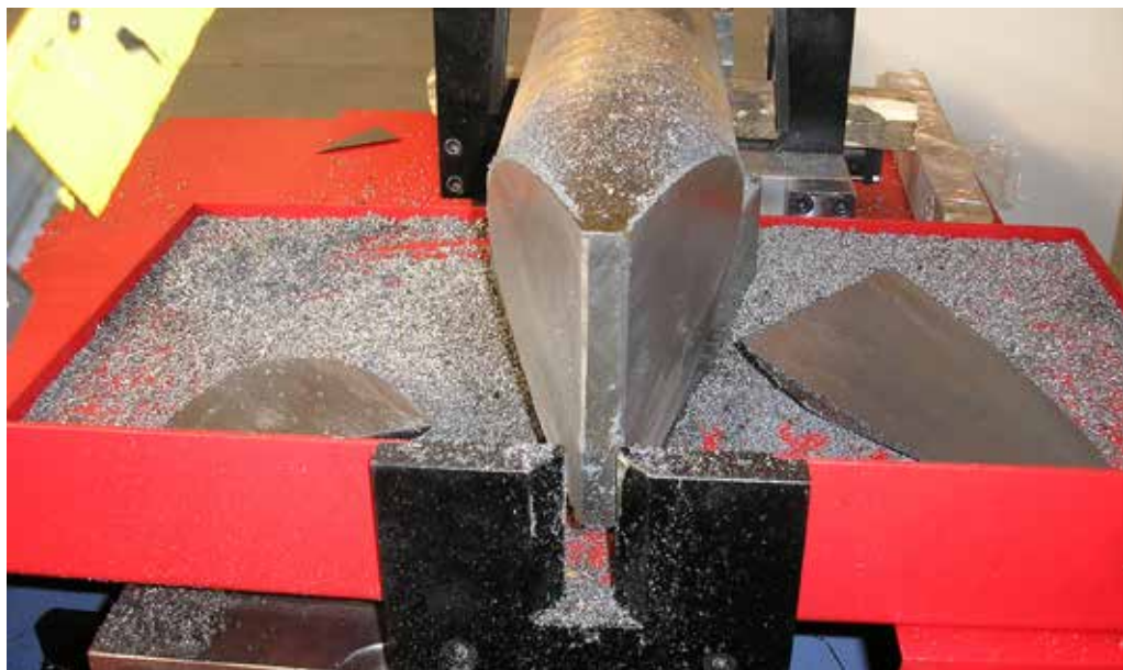
Taglio punte martelli pneumatici Pneumatic hammer head cutting
