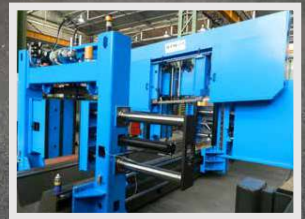
800 x 800 corsa 13.000 mm, arco inclinato 5° 800 x 800 carriage stroke 13.000 mm, 5° tilted bow
