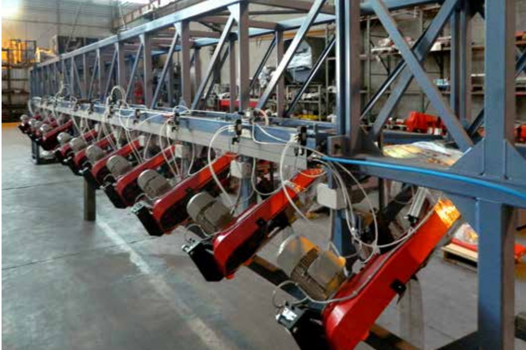
11 teste automatiche per taglio tiranti Ø 10-120 mm da 1 a 12 m - 11 automatic heads for rebar cutting, Ø 10-120 mm, lengths from 1 to 12 m
